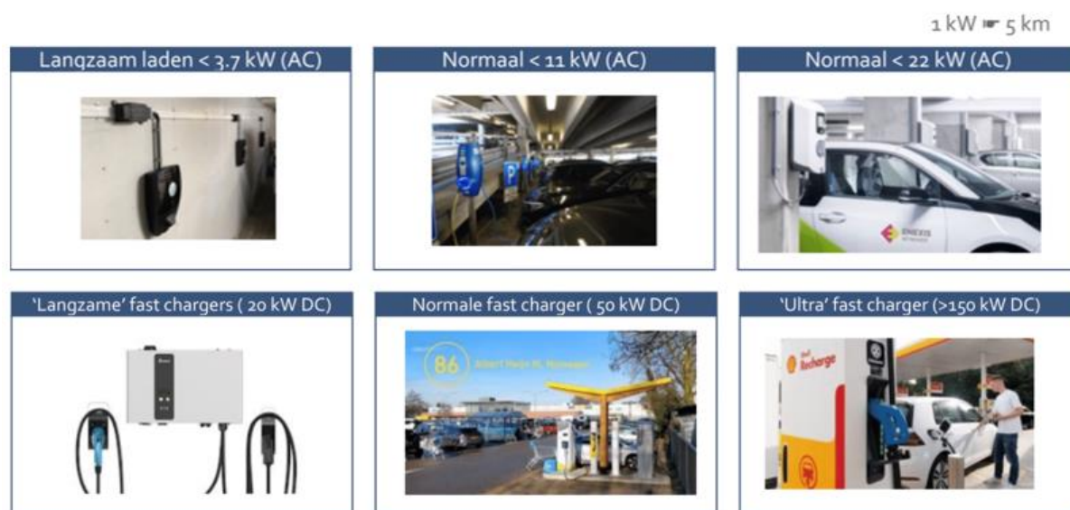
Figuur 3: Soorten laadpalen en bijbehorende vermogens
