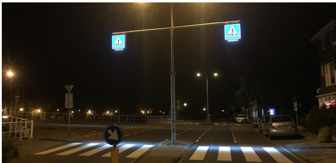
Figuur 9: VOP-lichtbak met verlichting (foto: Gemeente Leiden)
