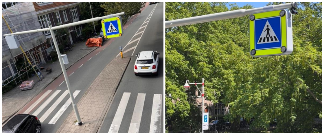
Figuur 10: VOP-lichtbak met extra attentie (foto: Sysconnect)
